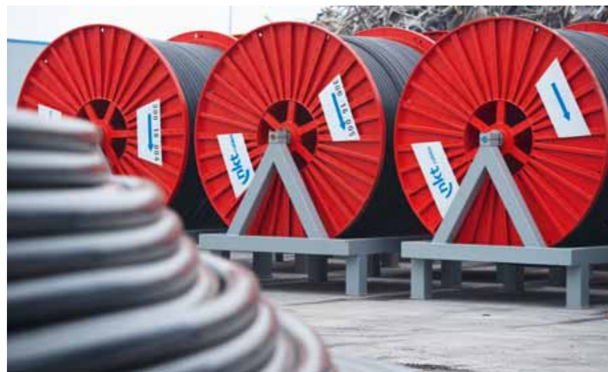
Высоковольтный кабель перед отправкой к месту назначения
